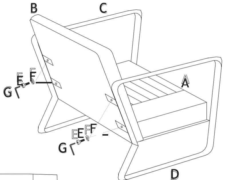
Remarque : Serrez d'abord partiellement les vis et lorsque l'ensemble du produit est assemblé, serrez complètement les vis.
