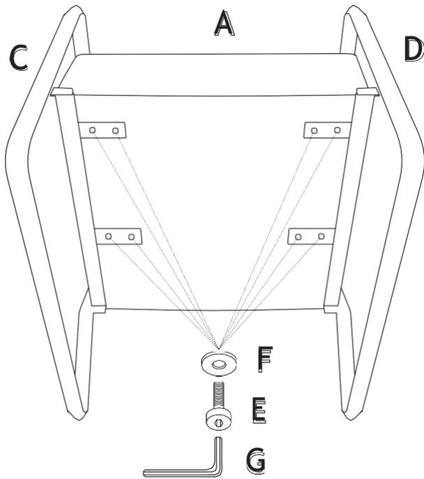
Étape 1 : Assemblez le siège avec les accoudoirs, puis serrez les vis, de sorte que nous puissions facilement remonter.
